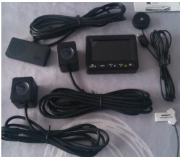
Caméras, enregistreur, GPS, bouton et un adaptateur USB pour micro SD.
